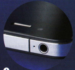
Для подавления шумов во время разговора используется дополнительный микрофон, находящийся около разъема для наушников.
