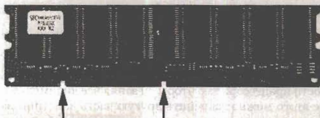
Рис. 20.8. Ключи на модуле памяти
